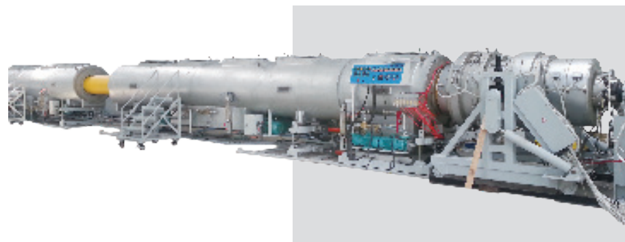
800mm 真空噴霧冷卻水槽
